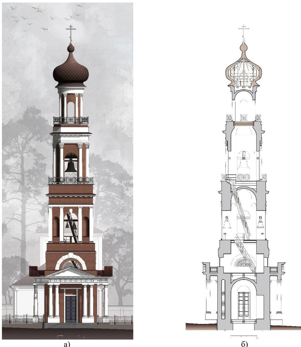
Рис. 5: а) Графическая реконструкция западного фасада колокольни; б) Графическая реконструкция разреза колокольни (иллюстрации авторов)
